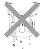
Ouvrir la porte du réfrigérateur et vérifier l'absence de fuite au voisinage du filtre.
