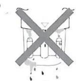
Abra la puerta del refrigerador y examine si la zona del filtro tiene fugas.
