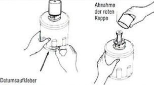
**3** Filter so positionieren, dass die etikettierte Seite des Filters sich bei der Anzeige befindet, so dass er in das Filtergehäuse eingeschoben werden kann. Drehen Sie die Kartusche eine viertel Umdrehung nach rechts, um sie fest zu ziehen. Sie spüren einen Widerstand und das Verriegelt-Symbol befindet sich nun auf einer Linie mit der Anzeigeleiste.
