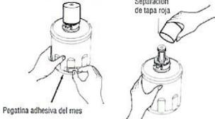
**3** Alinee el lateral sin marcar del filtro con la línea del indicador de forma que pueda insertarse en la cubierta del filtro. Gire el cartucho un cuarto de vuelta hacia la derecha para fijarlo en su lugar. Sentirá un tope y el símbolo "cerrado" debe estar ahora alineado con la línea del indicador.
